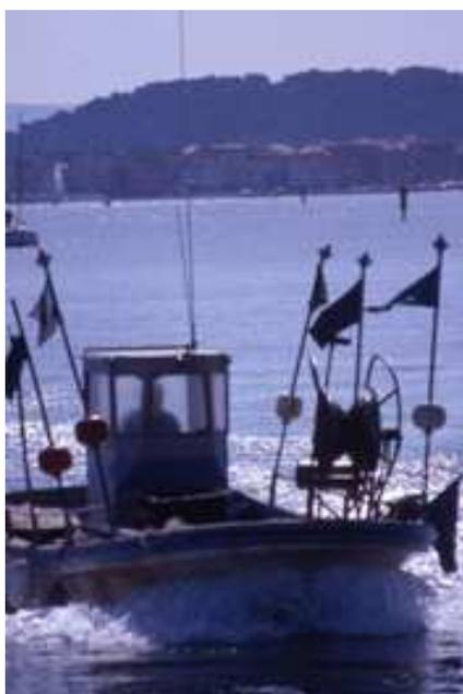
*Une roue hydraulique placée à l'avant du bateau permet de remonter les filets à bord*
