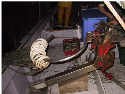
La fin du filet est passée dans la roue hydraulique suspendue à la grue, commence la lente mise à bord combinée au rangement. De temps en temps un poisson menace de tomber sur la tête des hommes qui se protègent avec leur capuche.
